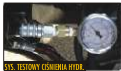
SYS. TESTOWY CIŚNIENIA HYDR.
