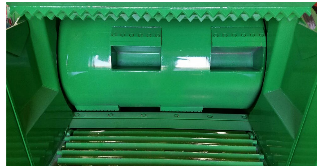
Bęben nożowy dla rozdrabniaczy horyzontalnych Beast
