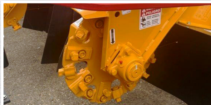
Tarcza frezowa New Revolution z frezami sześciokątnymi 24
